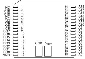
34-Pin POWERCAP MODULE (PCM) (USES DS9034PC POWERCAP)
